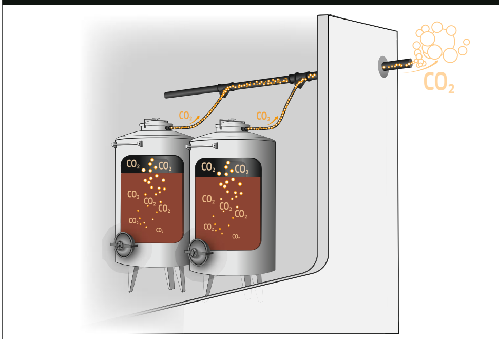
SCHÉMA DU CIRCUIT D'ÉVACUATION DU CO 2 PRODUIT LORS DE LA VINIFICATION
