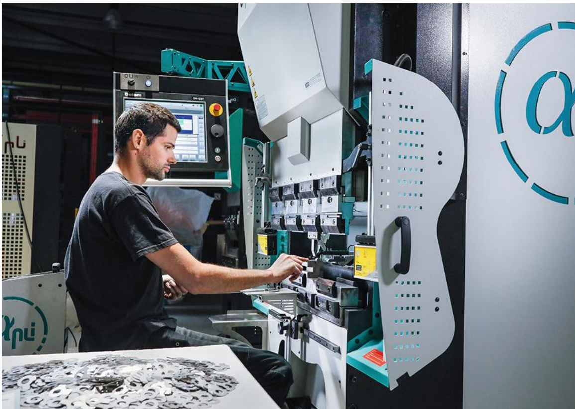
Test de fonctionnement sur une presse plieuse électrique, avant sa mise en production dans l'entreprise.
