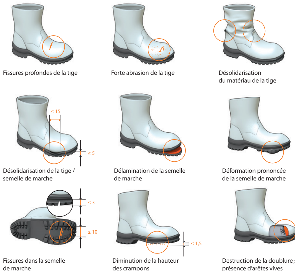
■ Figure 27. Signes de dégradation
