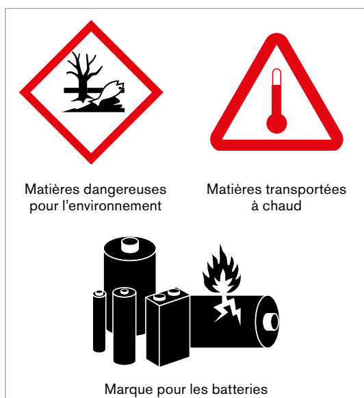
Figure 5. Marques de l'ADR
