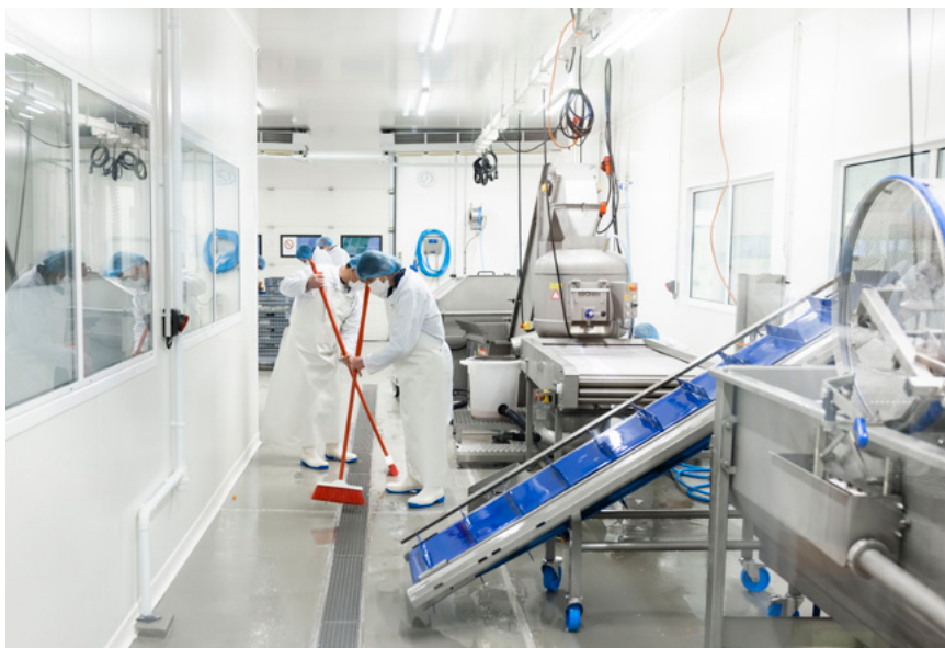
■ Figure 2. Équipements de travail sur pieds facilitant le nettoyage du sol
