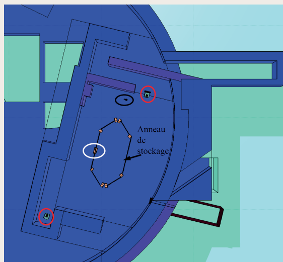
Figure A3 : Modélisation de la casemate béton abritant l'accélérateur Thom X utilisée pour les études par simulation numérique (Visualisation par l'interface FLAIR) [2] pour le code de calcul FLUKA [3 à 5]
