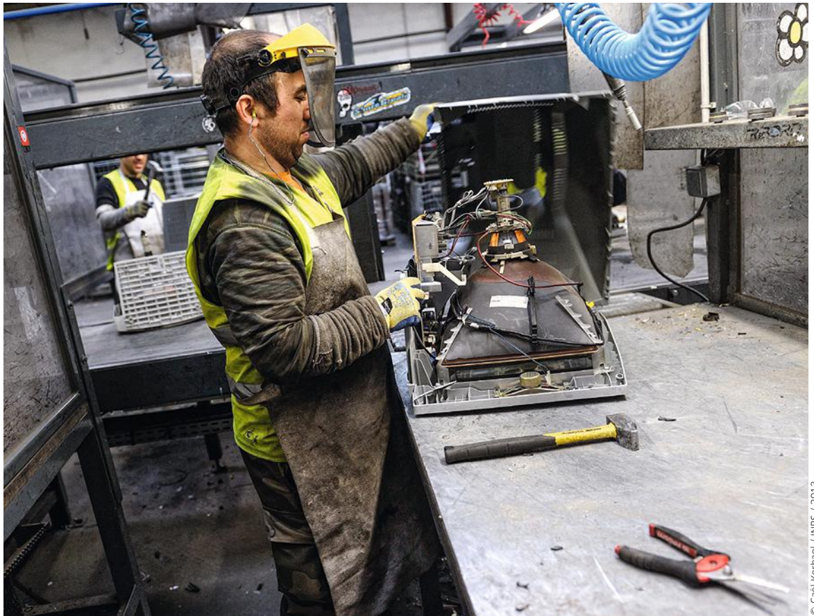
Traitement de déchets d'équipements électriques et électroniques (DEEE) pouvant contenir des Pfas.
