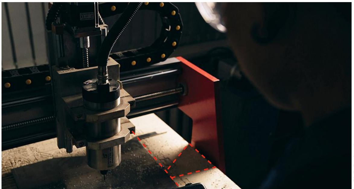
FIGURE 14 → Ombre perçue et variation de luminosité du plateau de la machine (zones délimitées en rouge). Cette différence correspond à une variation de luminance due à un éclairage non uniforme.
