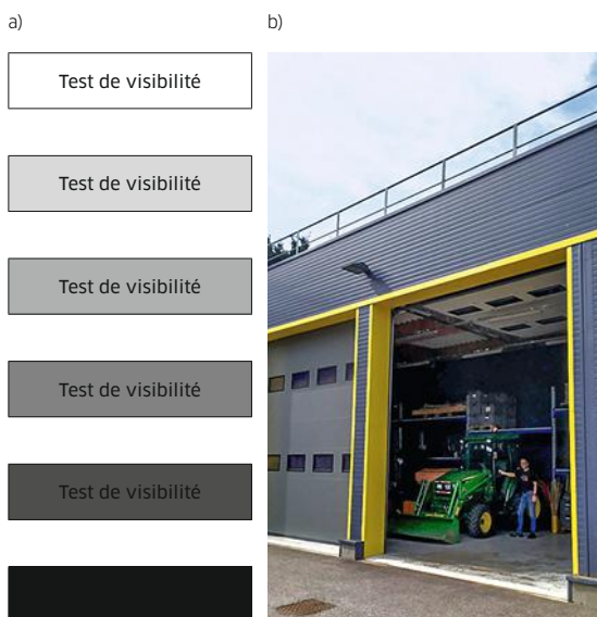
FIGURE 16 Lien entre le contraste de luminance et la visibilité d'un objet. Lorsqu'un objet a la même luminance que le fond sur lequel il doit apparaître, sa visibilité devient nulle. a) Affichage d'un texte en noir sur un fond de niveau de gris variable. b) Difficulté à percevoir l'environnement intérieur depuis l'extérieur : risque de collision engin-piéton.
